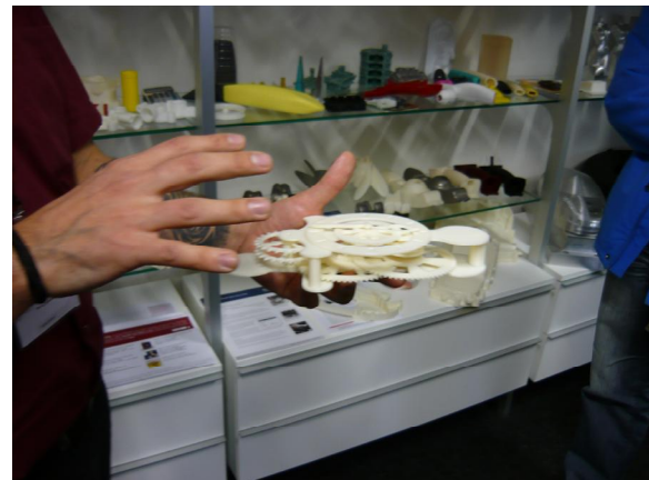
3D tisk – funkční prototyp mechanického strojíku.
