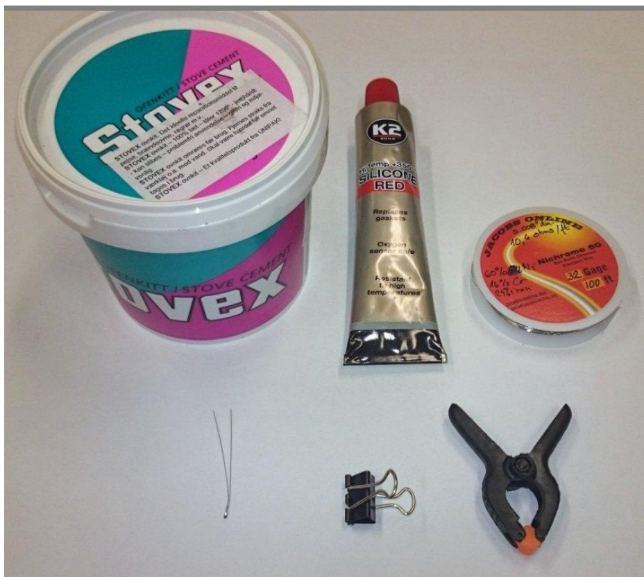
Obr. 78: Proprietu potřebné při opravě tavné hlavy
