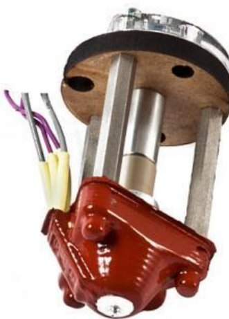
Obr. 75: Tavná hlava extruderu tiskárny RapMan 3.1 [41]
