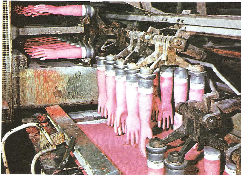
Obr. Výroba gumových rukavic – vyrábějí se máččením forem do lázní s latexem, kdy po vynoření zůstává na formě tenká vrstva hmoty. Tloušťka rukavice se řídí několikanásobným opakovaným ponořením.
