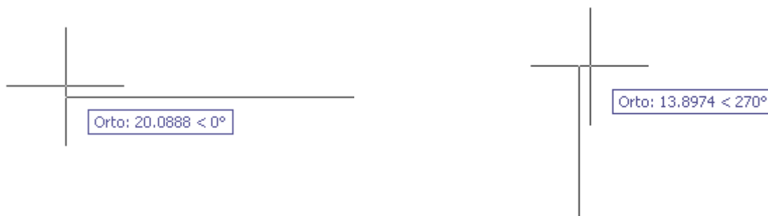
Obr. č. 6.3: Polopřímka horizontální a vertikální se zadáním na příkazové řádce ORTO a DYN
