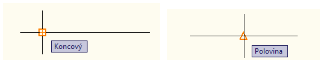
Obr. 2.5 kreslení úsečky s aktivovanými úchopovými bodami.
